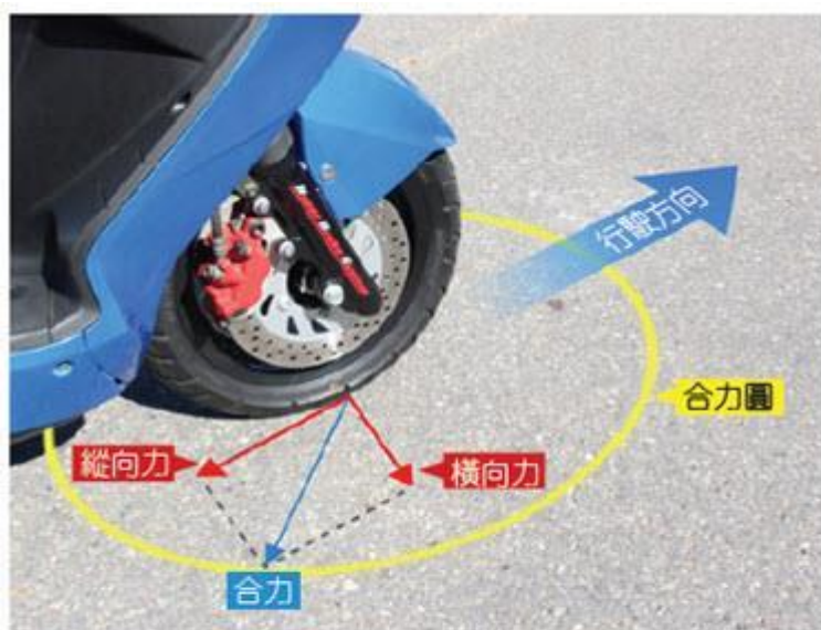
▲ 縱向力(煞車或驅動力)與橫向力(轉向力)的合力不會超過合力圓(抓地力界限)。
